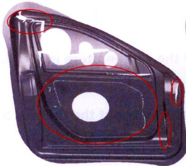
2-stufige Kaltumformung mit Zwischenwärmebehandlung
