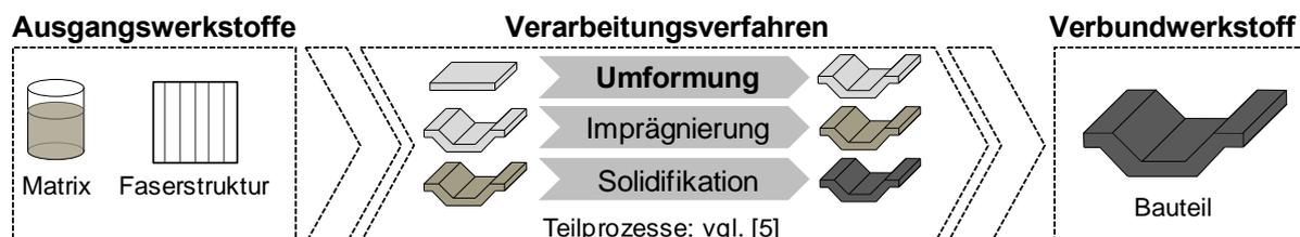
Abbildung 1: Vereinfachte Darstellung der Prozesskette zur Herstellung von CFK-Schalenbauteilen.
