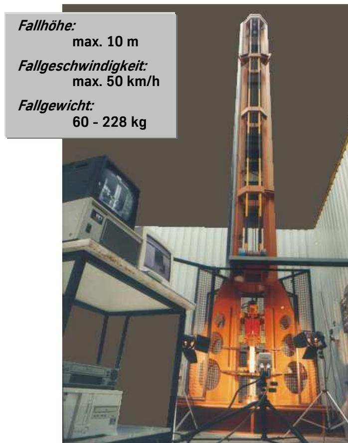
Bild 4 Fallturm am Standort Dortmund der ThyssenKruppStahl AG; Im Vordergrund mit Aufzeichnungseinheit und Hochgeschwindigkeitskamera
