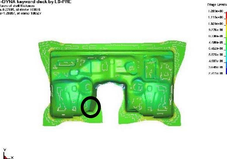
Bild 6: Blechdicke im Umformnetz
