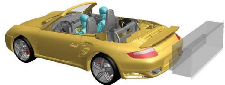
Berechnung eines Fahrzeugaufpralls mit LS-DYNA
