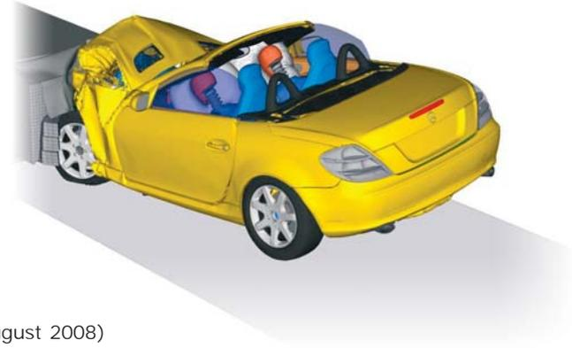
Berechnung eines Fahrzeugaufpralls mit LS-DYNA
