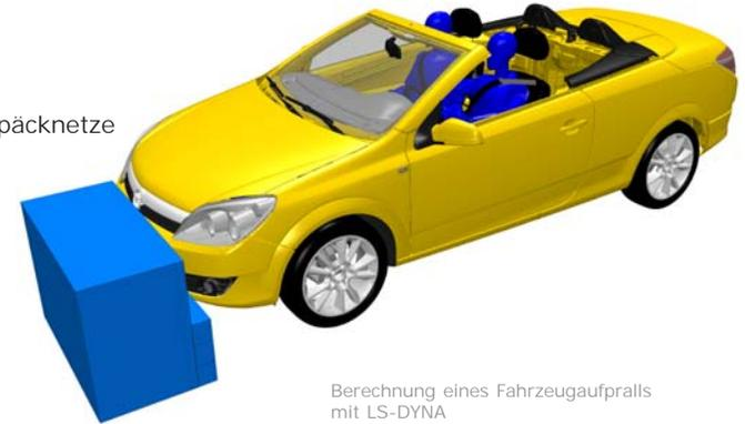
Berechnung eines Fahrzeugaufpralls mit LS-DYNA
